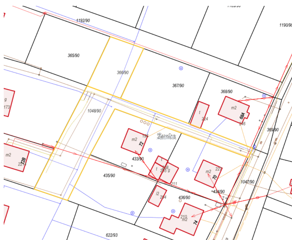
Rysunek 3 Fragment mapy z uzbrojeniem terenu
